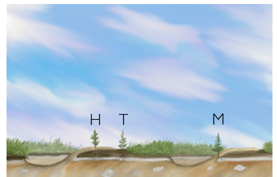
Le Bracke M36.b forme des microsites de plantation d'humus retourné (T), de sol minéral sur humus retourné (H) et de sol minéral sur sol minéral (M).
