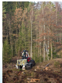
Bracke M24.a på en medelstor skotare ger ett mycket bra markberedningsresultat på alla högläggingsmarker.
