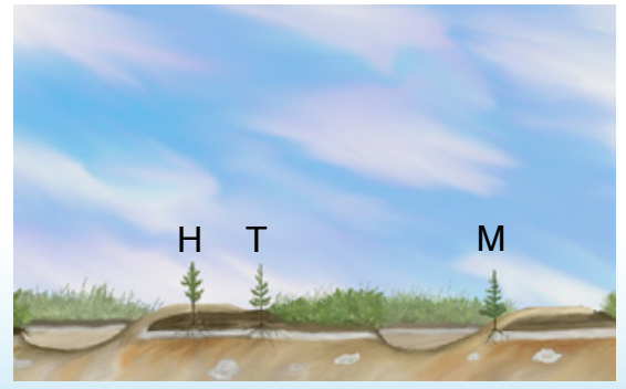
Bracke M24.a muodostaa istutus- tai kylvöpaikkoja kaksin kerroin käännetystä kunnasta (T), kaksinkerroin käännetystä kunnasta ja kivennäismaasta (H) tai kivennäismaasta (M).
