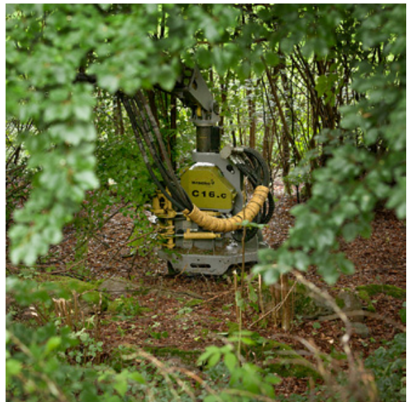
Bei Bracke C16.c handelt es sich um ein akkumulierendes Fällaggregat für Biomasse und Waldbau.
