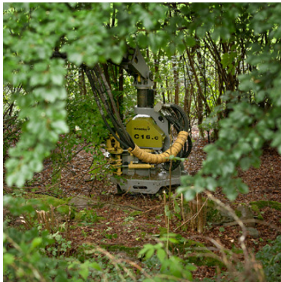
Bracke C16.c, tête d'empilage à accumulation destinée à la bioénergie et à l'entretien forestier.
