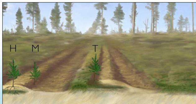
Bracke T28.b формирует посадочные места с перевёрнутым дёрном (Т), холмики из минеральной почвы на перевёрнутом дёрне (Н) и холмики из минерального грунта на минеральной почве (М).
