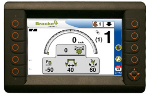
Näytöstä muutetaan mätätäjän asetuksia ja luetaan esim. työmaatietoja.
