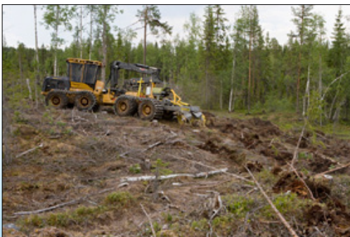
Bracke T28:a kuormatraktoriin asennettuna.
