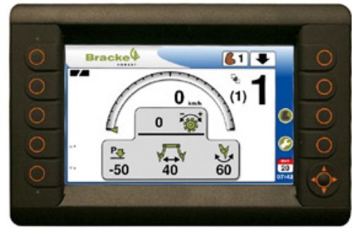
Display för inställningar och kontroll av harven.
