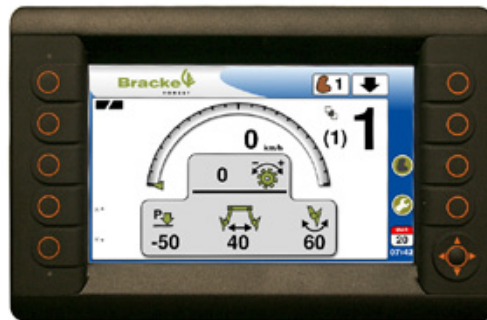
Bracke Growth Control är ett PLC-baserat styrsystem.
