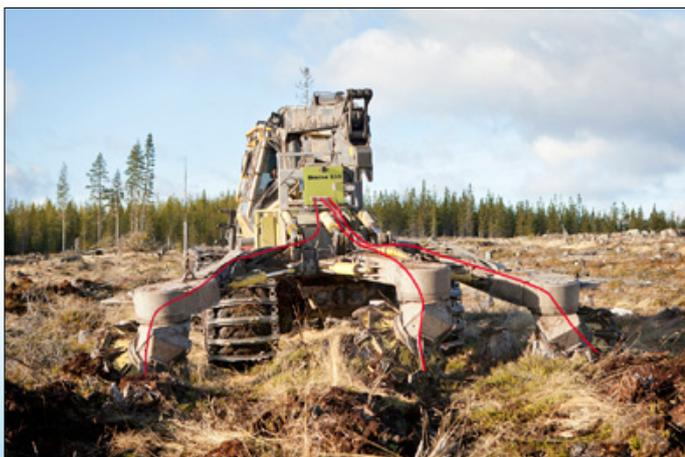
Le Bracke S35.a peut être monté sur une tête de conditionnement du sol à une, deux ou trois rangées.
