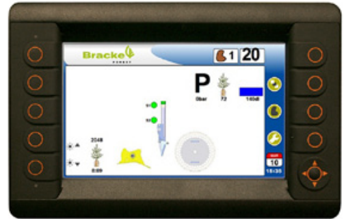
Le système de commande Bracke Growth Control est basé sur PLC.
