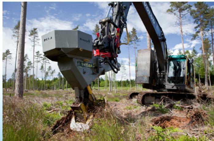
Mit Modell PI 1.a wird eine Bodenaufbereitung und Pflanzung durchgeführt.
