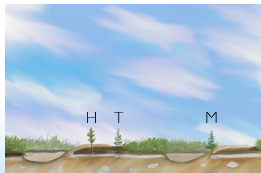
Bracke M36.b skapar planteringsställen med omvänd torva (T), mineraljordshög på omvänd torva (H) samt mineraljordshög på mineraljord (M).
