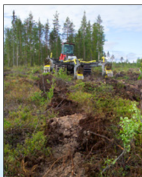
La plantation dans l'humus retourné à l'aide du M36.b permet de bonnes conditions de production élevée.
