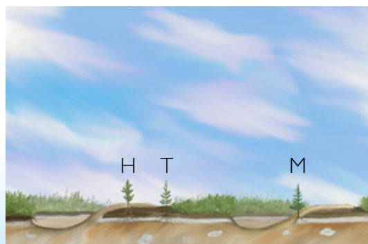
Le Bracke M36.b forme des microsites de plantation d'humus retourné (T), de sol minéral sur humus retourné (H) et de sol minéral sur sol minéral (M).
