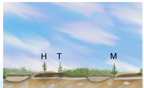
Bracke M24.a skapar planteringsställen med omvänd torva (T), mineraljordshög på omvänd torva (H) samt mineraljordshög på mineraljord (M).
