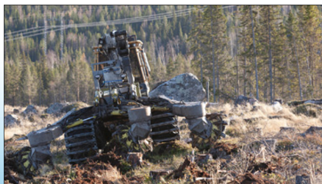
Bracke T35.b är lämplig för de större markberedningsobjekten och monteras på stora basmaskiner.
