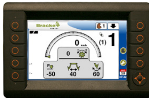
Display för inställningar och kontroll av harven.
